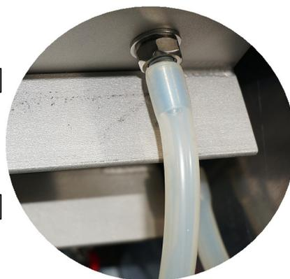
**Шаг 2.** В зависимости от модели упаковщика различается расположение воздушной подушки (подушек). Подушка расположена под каждым нагревательным элементом. Сообразно расположению нагревательных элементов взгляните на внутреннюю стенку корпуса под нагревателем. Вы увидите металлический штуцер и подведенный к нему шланг (фото 9) .
