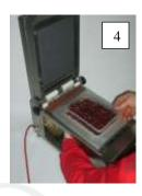
2. Вставьте пластиковый лоток, в котором находится Ваш продукт, в матрицу. Натяните пленку, накрывая ею поверхность лотка. Закройте крышку оборудования и через 3-4 секунды откройте её снова. Заберите лоток и повторите ту же самую процедуру со следующими лотками. \*\*\*Для проверки уже упакованных лотков, дождитесь охлаждения поверхности.
